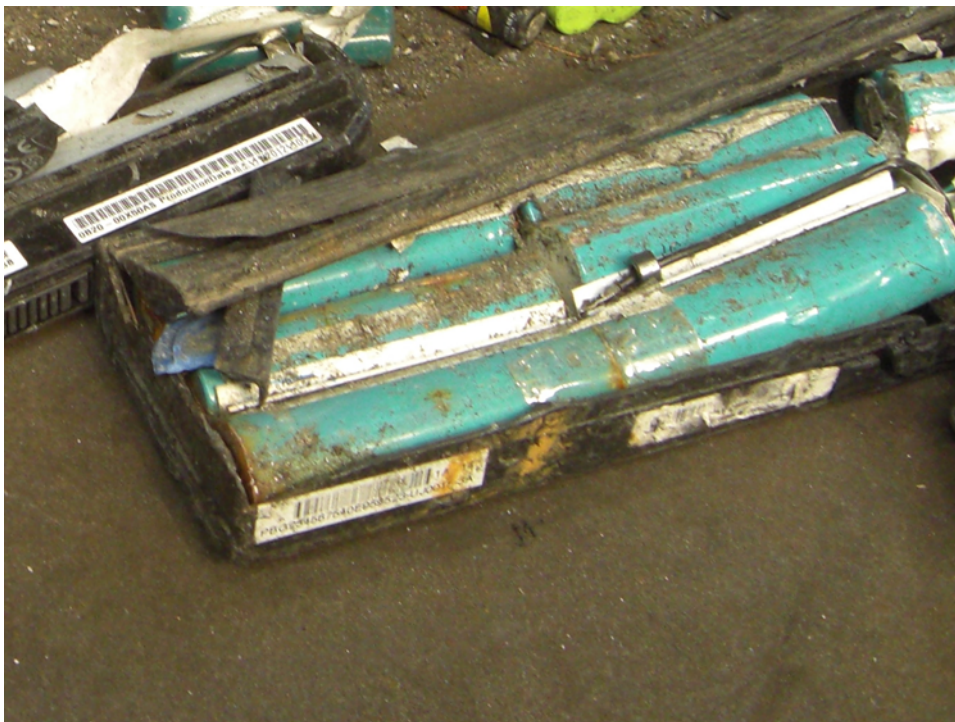
Abbildung 13: Geöffnete Notebookbatterie mit Rundzellen vom Typ 18650
